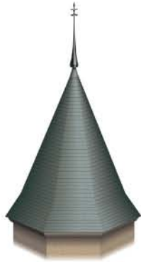
toit M à tourelle F à pans M sloped turret cubierta F de torrecilla F Faltkegeldach N torretta F spiovente
